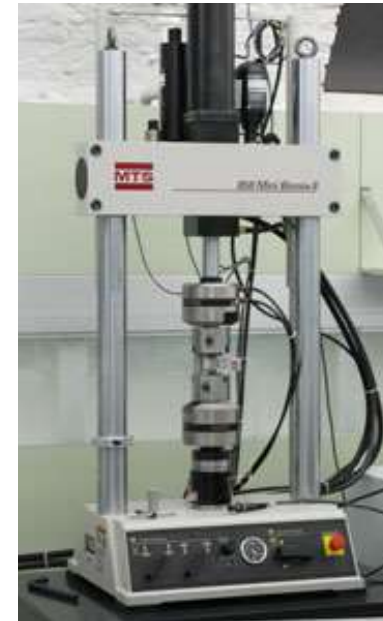
MTS 858 Mini Bionix 25KN Axial, 250 Nm Torsional
